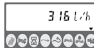
Visning 6: Øjeblikkeligt vandflow, dvs. angivelse af hvor mange liter fjernvarmevand, der cirkulerer gennem varmeanlægget i timen.
